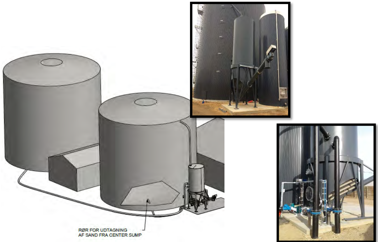
Figur 12. Fjernelse af sand på Rybjerg biogas
