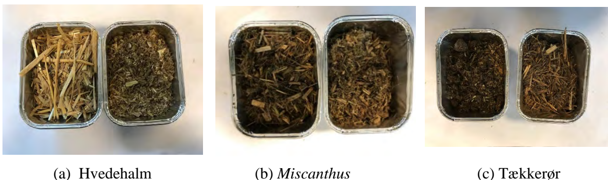
Figur 3. Biomasse før og efter grinding (Venstre: neddelt, Højre: Neddelt og grinded)
